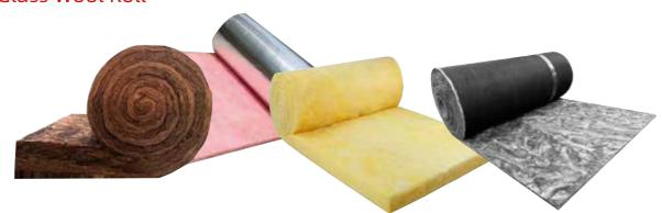
● 保温隔热玻璃棉毡是由长而富有弹性的玻璃纤维与热固性树脂粘合在一起,形成轻质柔韧的玻璃棉卷毡。我们可以根据项目设计和客户需求,可以制作黄色,粉色,棕色环保棉和黑色等系列,可以提供多种不同的隔汽膜和装饰面,如: 铝箔夹筋贴面,PVC贴面,VR贴面,牛皮纸贴面,以及多种进口高端贴面。
