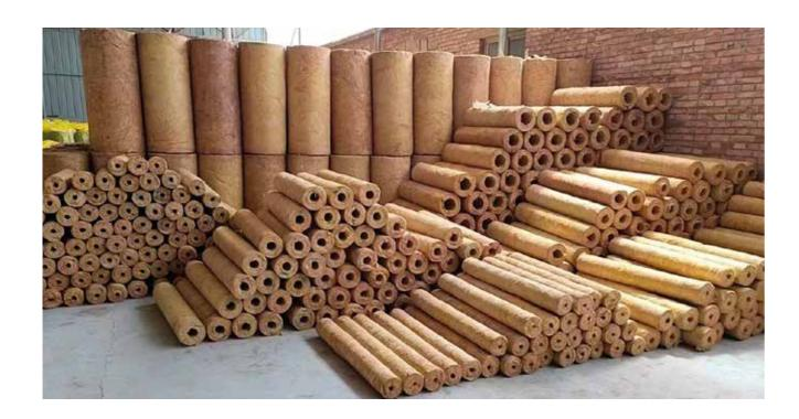
● 保温岩棉管由岩棉纤维用模具卷制并经高温固化成型,为方便安装,沿管壳轴线方向单边 剖缝开口,齐头,方便施工,可以确保管壳与需要保温的管道紧密配合。管壳外表面可以根据 客户要求进行打磨以确保保温厚度的精确一致,还可根据客户要求生产憎水型和低氯型产品或 在表面加贴铝箔、玻纤等材料。岩棉管专为在 -20° C 至 450° C 温度范围内运行的冷热管道系统而设计。适用于冷藏线,热水,蒸汽和冷凝水管线,以及商业和工业应用。
