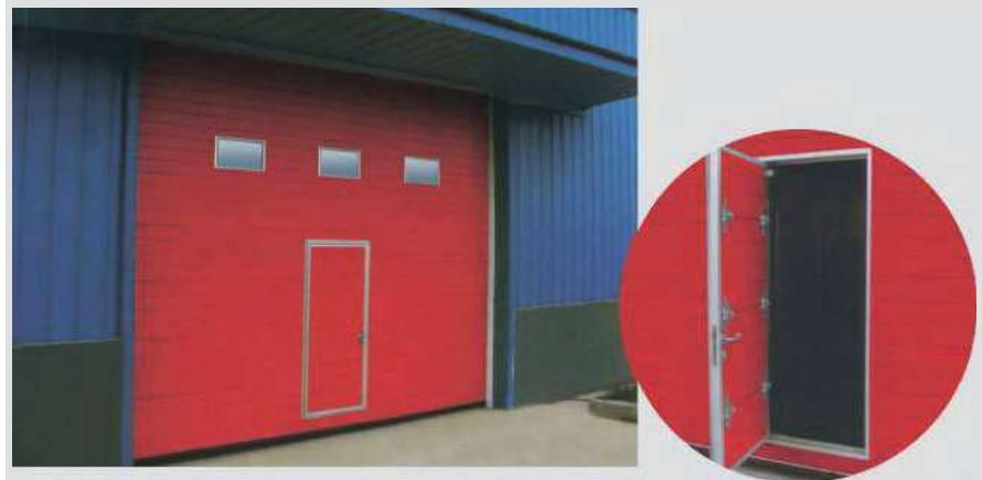
★**工业提升门**适用于厂房、仓库，快速美观，门板外层为金属彩钢板，中间填充聚氨酯发泡，从而降低了门板自重，提高保温质量，使门体上下运行更平稳。门体上可安装透视窗口，增加采光量，也可以安装小门，使进出更加方便。
